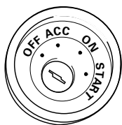
Замок зажигания, на котором предусмотрено положение АСС
