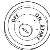
Assenza di posizione ACC
